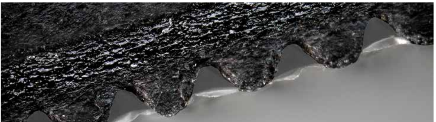
Uitvergroting onderzijde van de rol voorzien van 'grooves'.
